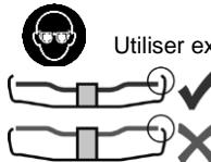
Utiliser exclusivement des outils accessoires, qui sont au minimum en retrait de 3,4 mm par rapport au garde de protection. Utiliser des intercalaires souples s'ils ont été fournis avec l'accessoire de meulage et que leur utilisation s'impose. Respectez les indications de l'outil ou du fabrication d'accessoires ! Protéger les disques des graisses et des coups ! Les meules doivent être conservées et manipulées avec soin, conformément aux instructions du fabricant.
