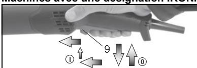
**Mise en marche :** mettre la machine en marche tel que décrit ci-dessous. Pousser à nouveau la gâchette (9) vers l'avant et le relâcher en position antérieure pour bloquer la gâchette (9) (déclenchement).
