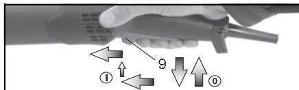
**Conexión:** encienda la máquina tal y como se describe más arriba. Ahora volver a deslizar hacia delante el interruptor (9) y soltarlo en la posición delantera para que el interruptor (9) quede bloqueado (funcionamiento continuado).
